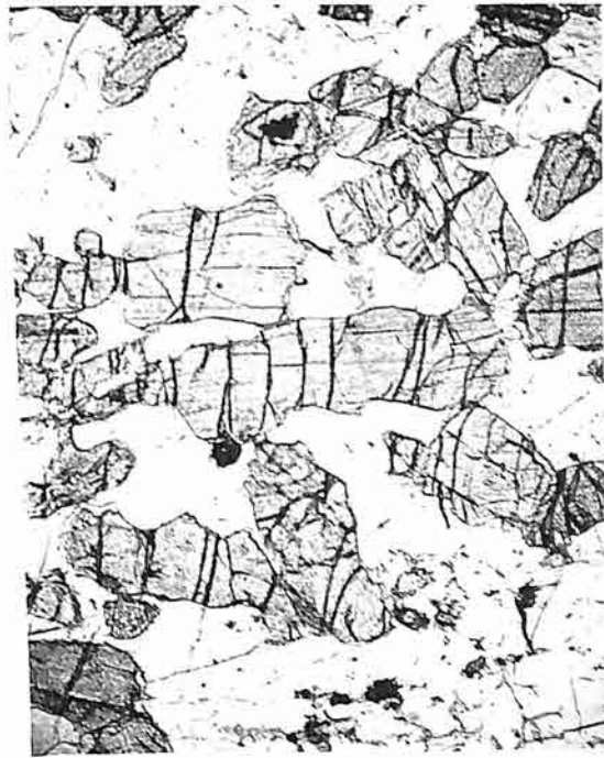
Fig. 2. Oblong orthorhombic pyroxenes in norite. \times 20 . (V. 695).
