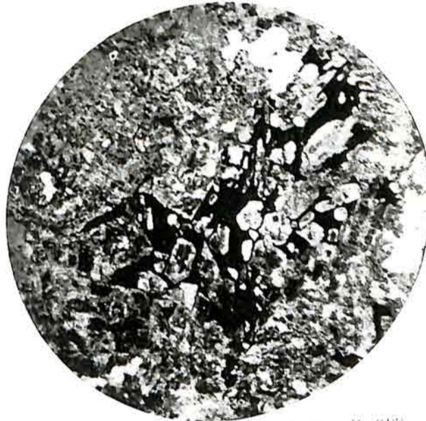
Fig. 4. Ore-skeleton in epidiorite. \times 18 . (V. 912).
