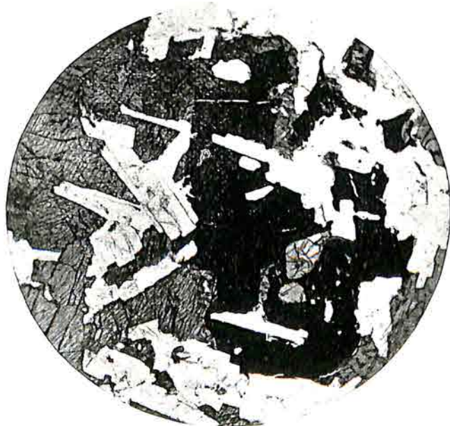
Fig. 5. Ilmenite dissected by plagioclase. Quartz gabbro. \times 22 . (V. 246).
