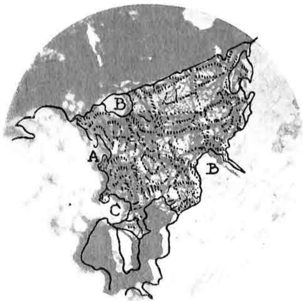
Fig. 5. Fluorite in biotite gneiss, S. 49. (X. 9619.)
