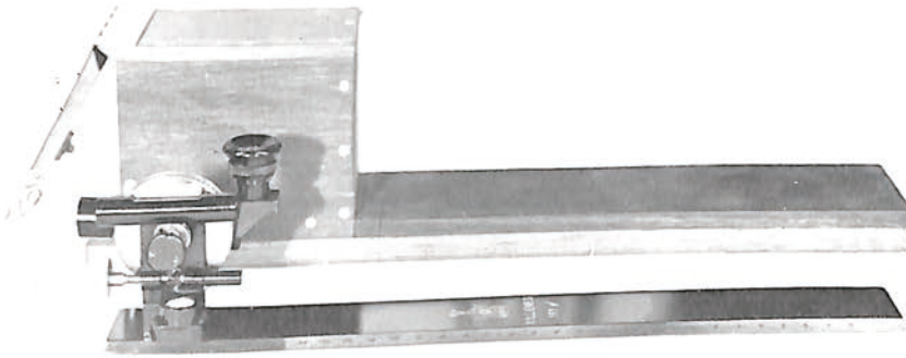
FIG. D. Règle à éclinètre GOUTIERE
